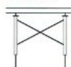
Ram H=1800 mm med krysstag 2400 x 1200 mm
